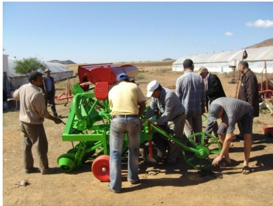
*Montage et réglage du semoir 12 rangs au Maroc*
